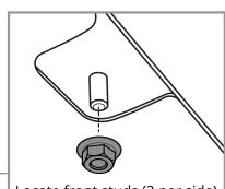
Locate front studs (2 per side) Middle stud (1 per side) Rear (2 per side)
